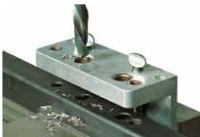
Dima di foratura E72751 + E72760 Drilling template for E72751 + E72760
